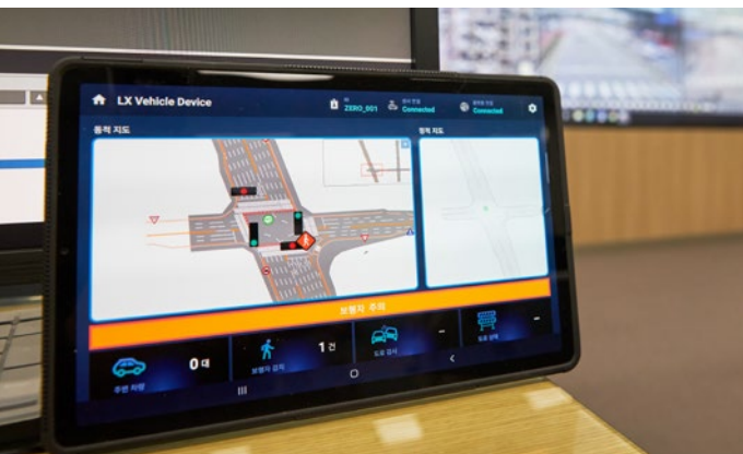
그림은 LX공사에서 개발한 자율주행 공간정보 플랫폼의 데이터를 표준화하여 수집하고, 서비스하는 단말기의 모습이다.
